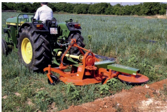
Desbrozadora de tractor, con dos discos fijos y uno móvil, segando una cubierta de veza-avena entre naranjos jóvenes.
